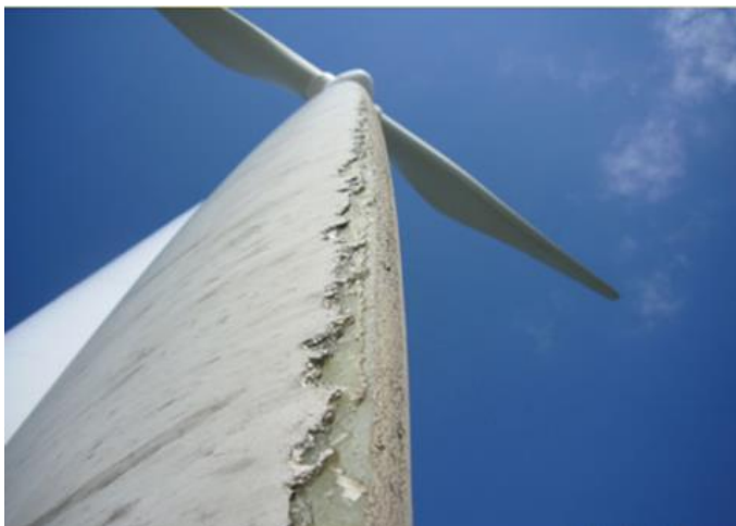
Figuur 12. Foto van een door erosie aangetast rotorblad
